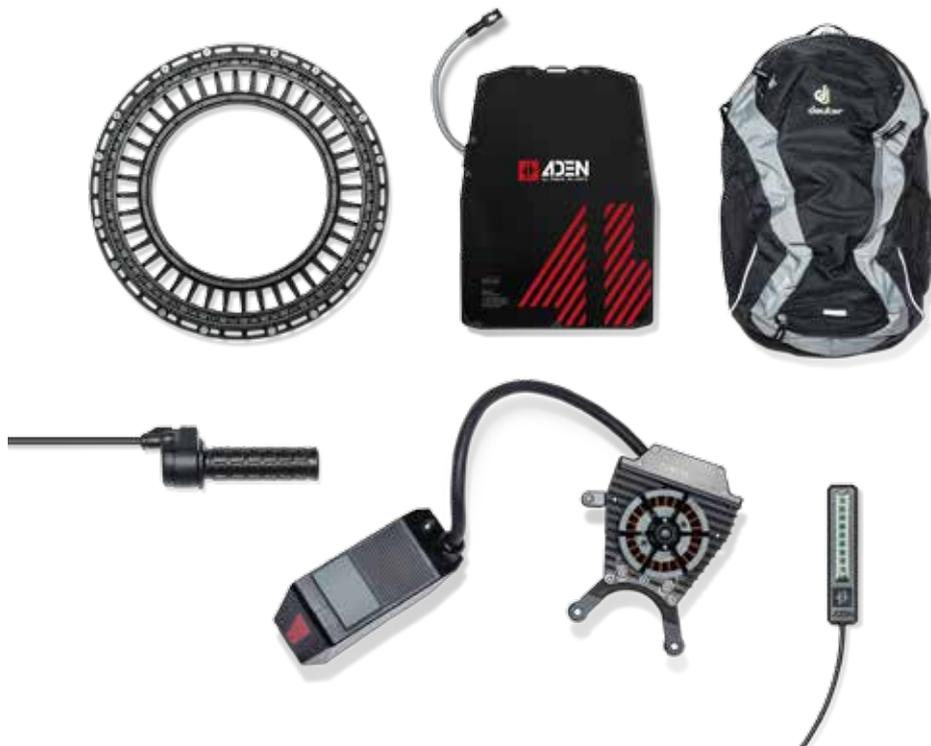
**Powerkit Pro beinhaltet:** Antriebsscheibe, Rucksack mit Akku und Akkuladegerät, Gasgriff, Antriebseinheit, Energieanzeige.
