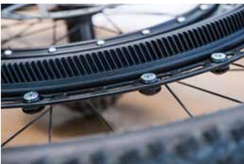
Bei 16 Speichen können Speichenklemmen in vormontierter Position belassen werden. Bei anderer Speichenzahl können Klemmen mit Hilfe des Inbus Größe 3 exakt verschoben werden.
