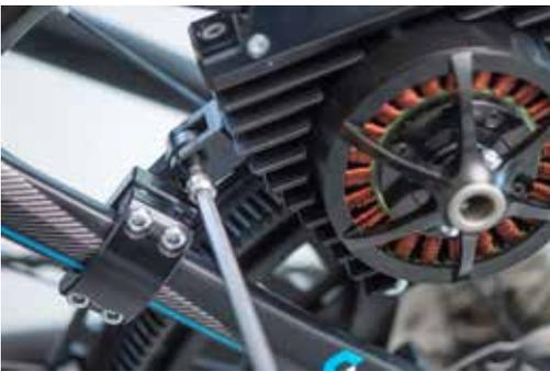
Motoreinheit mit Hilfe der mitgelieferten Schraube am Verbindungsstück anbringen.
