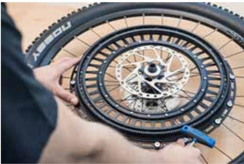
Fahrrad in Montageständer einspannen oder auf den Kopf stellen. Hinterrad ausbauen und Antriebsscheibe darauf mittig positionieren.
