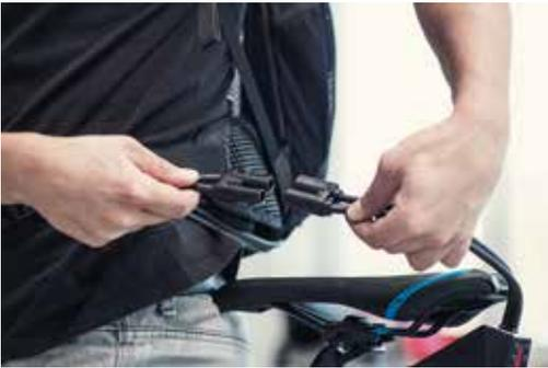
Aufsitzen und mit Hilfe des Steckers den Akku mit der Elektronik-einheit verbinden.
