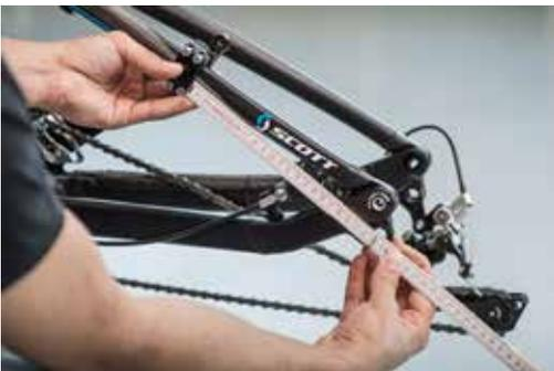
Rahmenhalterung am der oberen Strebe der Schwinge anbringen (Inbus Gr. 3). Der ideale Abstand zur Achsmitte beträgt 22cm. Schrauben mit ca. 5 Nm fixieren.
