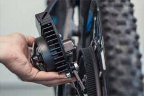
Die unteren zwei Lager des Motors in den inneren Ring der Antriebsscheibe einsetzen.
