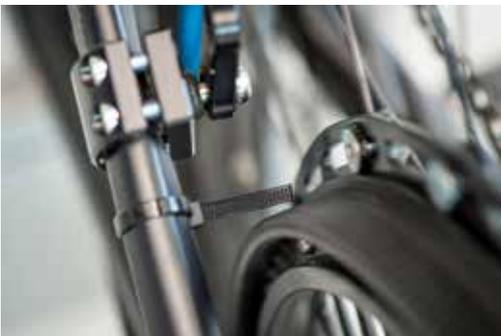
Alternativ kann auch ein Kabelbinder an der Schwinge befestigt werden. Jetzt Rad drehen und Rundlauf der Scheibe kontrollieren.
