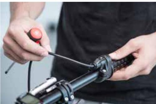
Am Lenker den rechten Fahrradgriff entfernen und den mitgelieferten Gasgriff anbringen und mit dem Kreuzschlitz fixieren. Das Kabel des Gasgriffs mit Hilfe der Kabelbinder am Rahmen entlang verlegen. Darauf achten, dass man den Gasgriff frei bewegen kann.
