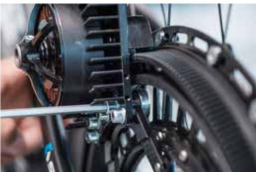
Mit dem Inbus Gr. 5 die verstellbaren Lager in der Mitte der Motoreinheit nach oben anlegen und fixieren.
