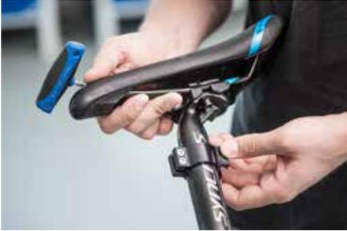
Befestigung für die Elektronikeinheit über die Sattelstange schieben und fixieren (Inbus Gr. 3). Sattel wieder anbringen.
