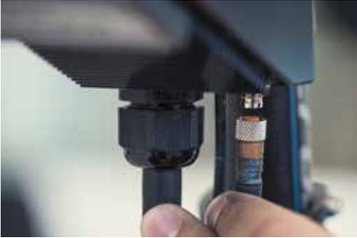
Stecker in die Buchse stecken und durch Drehung fixieren.
