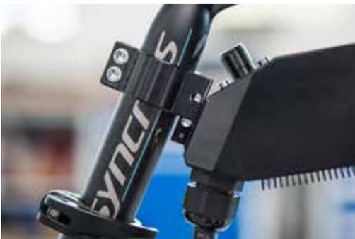
Elektronikeinheit in die Halterung schieben.
