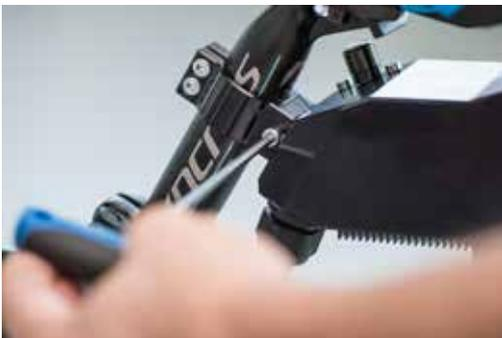
Elektronikeinheit mit der mitgelieferten Schraube fixieren (Inbus Gr. 3). Auf ausreichend Abstand zum Reifen achten, insbesondere bei Fahrrad mit gefederter Schwinge.
