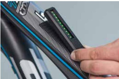
Akku-Anzeige in der Mitte des oberen Rahmenrohrs mit Hilfe des davor vorgesehenen Klettstreifens befestigen.
