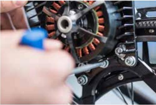
Die mittlere Schraube dient zur Winkeleinstellung des Motors.
