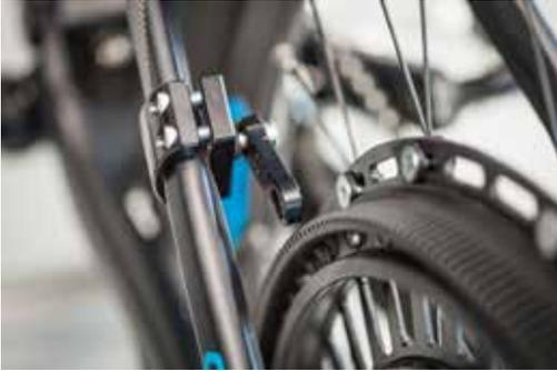
Um die Antriebsscheibe endgültig zu zentrieren, einfach das Verbindungsstück so ausrichten, dass es an der Antriebsscheibe anliegt. Jetzt Rad drehen und Rundlauf der Scheibe kontrollieren.
