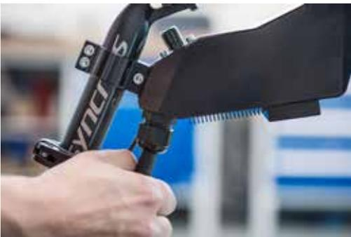
Durch Öffnen der Kabelverschraubung an der Elektronikeinheit kann das Motorkabel um ein paar cm verlängert oder verkürzt werden.
