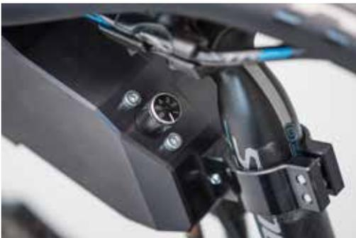
Für die grundlegende Einstellung stehen 6 Leistungsstufen zur Verfügung. Diese können über den Drehknopf oben an der Elektroneinheit eingestellt werden.
