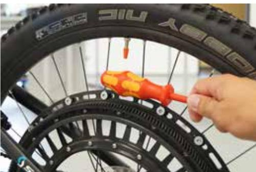
Das Rad drehen und den Rundlauf kontrollieren. Anschließend entsprechende Änderungen der Position durch Klopfen und Schieben vornehmen. Vorgang so lange wiederholen, bis Zentrierung erreicht. Danach Schrauben fest anziehen.
