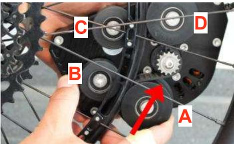
Über Rolle (A) wird die Riemenspannung eingestellt.
