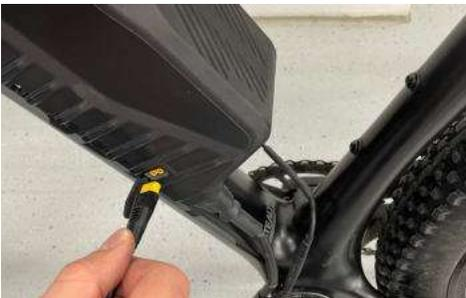
Zum laden den Akku einschalten, das Ladegerät in die Steckdose. Nun kann der Akku mit dem Ladegerät verbunden werden.
