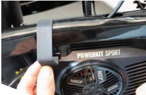
Den Rahmen mit der mitgelieferten Lackschutzfolie an den Kontaktflächen abkleben (langer Streifen).
