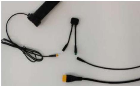
Nun die SWITCH-Box mit dem Gasgriff/Daumengas und dem Antrieb verbinden.
