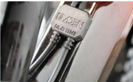
Nun die SWITCH-Box an eine beliebig freie Stelle am Rahmen platzieren, bei Bedarf mithilfe des 3M-Aufklebers befestigen.
