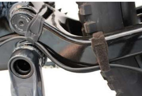
Anschließend das Akkukabel mit den beiliegenden Klettbandern am Rahmen entlang zum Akku verlegen.
