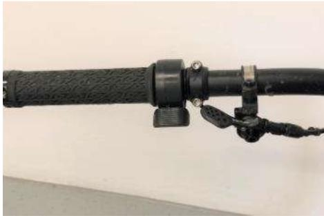
Der Daumenhebel wird an der gewünschten Stelle am Lenker mit einem Inbus 3mm montiert und entlang des Rahmens in Richtung der Antriebseinheit verlegt.
