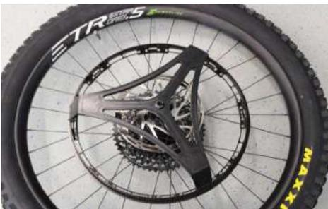
Den Ring auf die gegenüberliegende Seite der Kassette legen. Nun die Montagehilfe mit den drei Auslegern auf den Ring setzen und den passenden Achsadapter in die Bohrung der Montagehilfe stecken. Nun die Achse durch den Achsadapter und die Montagehilfe in die Radnabe führen.
