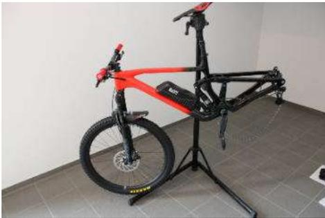
Das Fahrrad in einen Montageständer einspannen und das Hinterrad ausbauen.
