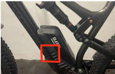
Bei vollgefederten Bikes darauf achten, dass beim Einfedern der Dämpfer nicht gegen den Akku stößt.
