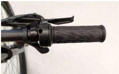
Alternativ kann auch der Drehgriff verwendet werden. Dieser wird immer auf die rechte Seite des Lenkers mit einem Inbus 3mm montiert. Die Kabelverlegung erfolgt wie im vorherigen Schritt.
