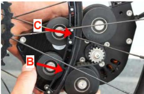
Die Laufrollen (B,C) fest gegen den Antriebsring drücken und anschließend die Schraube mit einem Inbus 4mm festziehen (max. 3 Nm).
