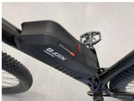
Bei geringem Akkuladestand, beginnt der Motor die Leistung zu reduzieren und sollte demnächst geladen werden.
