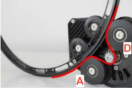
Zur Montage der Antriebseinheit wird zuerst der Riemen um das Antriebsritzel gelegt. Der Riemen muss vollflächig auf den Zähnen des Antriebsrings aufliegen. Antrieb nach Schaubild positionieren, sodass die Riemenrollen (A,D) in den Antriebsring greifen.
